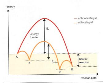
Fig. 2.7 THE DECOMPOSITION OF NITRIC OXIDE ON A CATALYST SURFACE.
